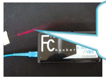
端面研磨品: 光が十分出ています。 (-10%(-0.5Db)以上)
